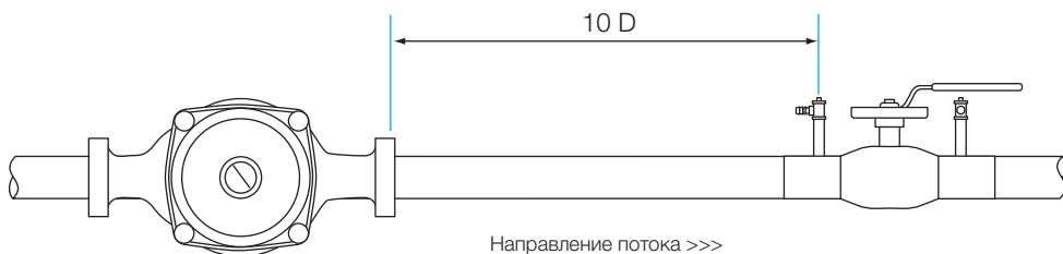
Рис. 3. Минимальные расстояния при установке
